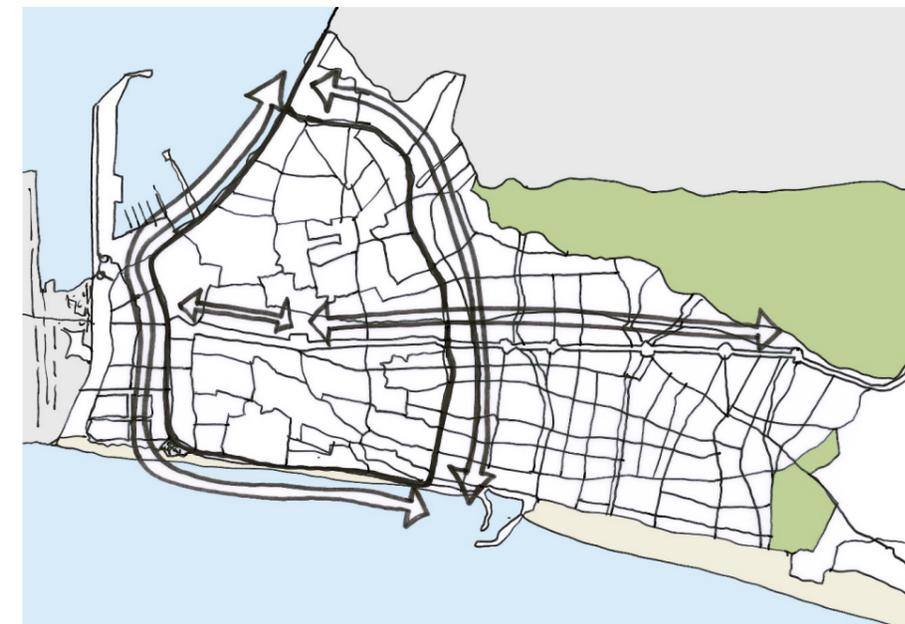
Esquema de la Estructura Viaria Principal, con el modelo “radio-concéntrico de Paseos del Litoral, Avda. Cartagena y Eje Norte, como principales elementos viarios estructurantes.
