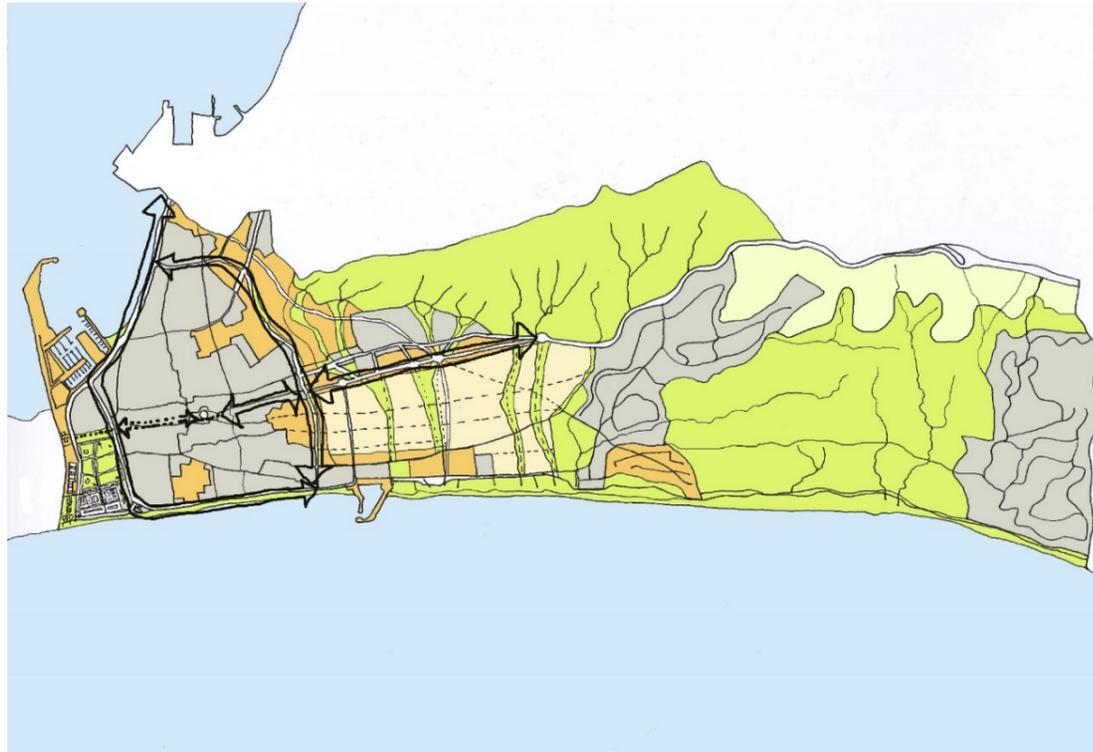
Esquema de la propuesta de la estructura viaria del Plan conformada con el modelo radio-concéntrico de ejes y rondas.
